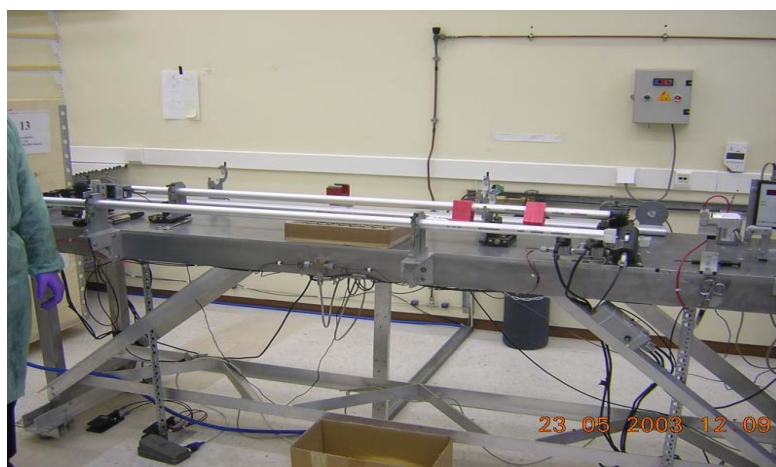
Κατασκευή θαλάμων μυνίων στο Πανεπιστήμιο Αθηνών
